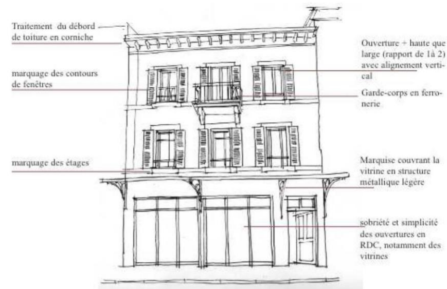
Illustration n°81. Schéma de principe d'une façade.
