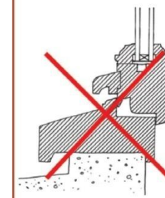
Profil moderne inadapté
